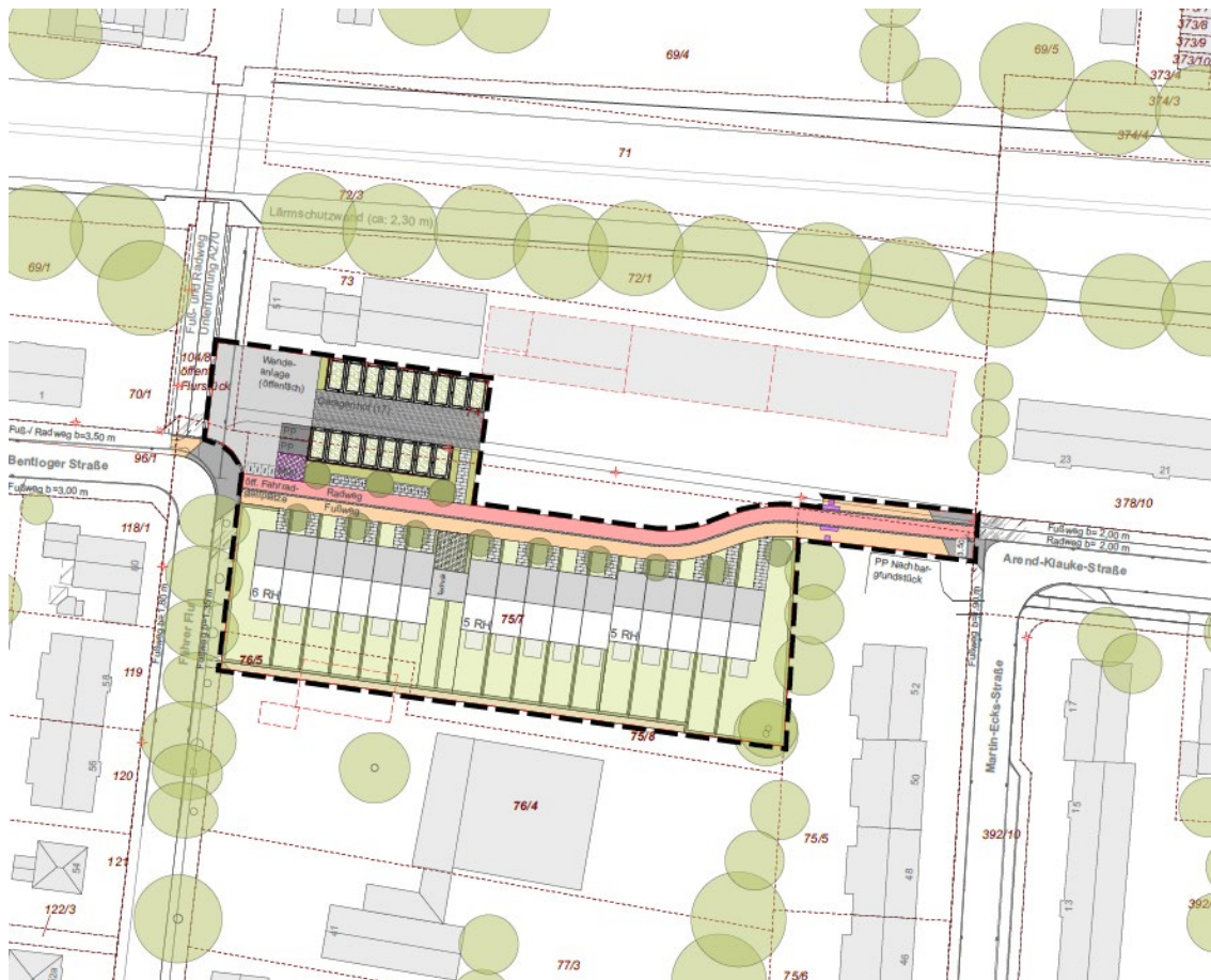
Abb. 3 Vorhaben- und Erschließungsplan (gestrichelter Bereich) mit ergänzender Darstellung der nördlich geplanter Kita (Verfasser: Atelier SchreckenberG GmbH, Bremen)
