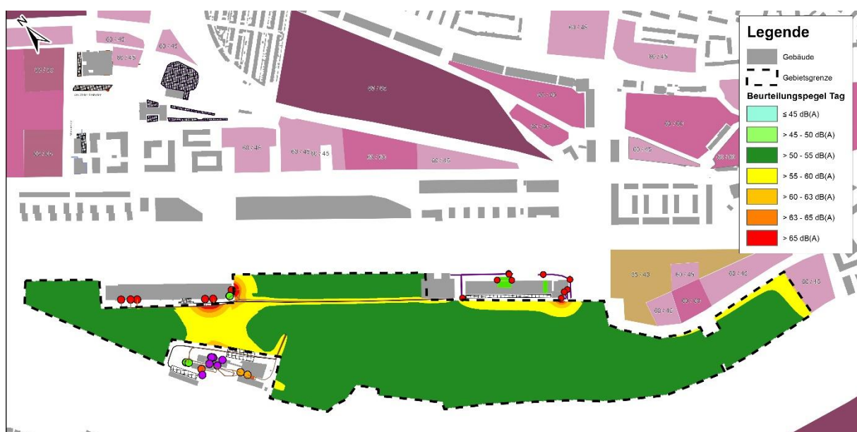
Abbildung 9: Anlage 2c: Schallimmissionsplan Gewerbe (Berechnungshöhe 5,4m) Vollers Teelogistik ohne Schuppen 4 & Rickmers Reismühle - Beurteilungspegel - Tag
