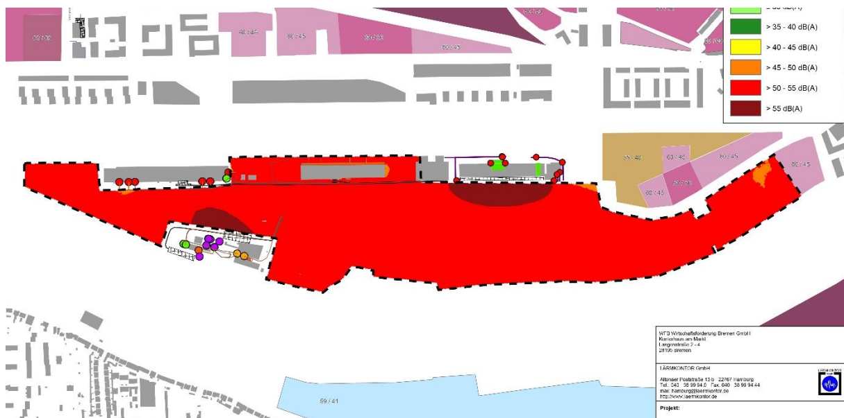
Abbildung 10: Anlage 2b: Schallimmissionsplan Gewerbe (Berechnungshöhe 5,4m) Vollers Teelogistik & Rickmers Reismühle - Beurteilungspegel - Nacht
