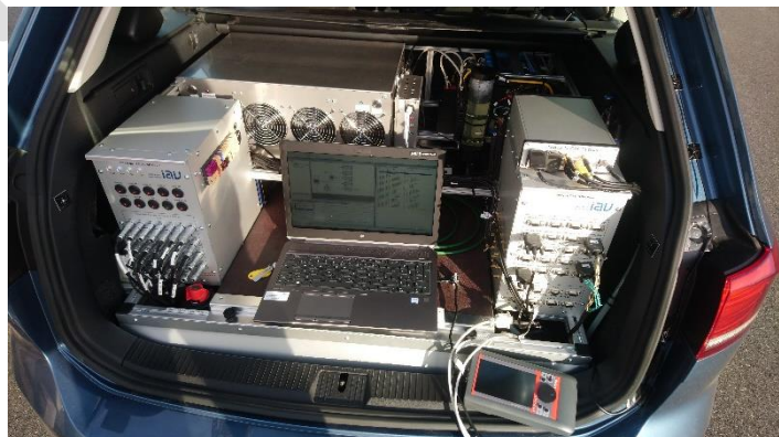
Abbildung 7: Erforderliches technisches Equipment im Kofferraum des OPA 3 L-Projektfahrzeuges zur Berechnung der intelligenten Steuerungssignale für das Prototypenfahrzeug.
