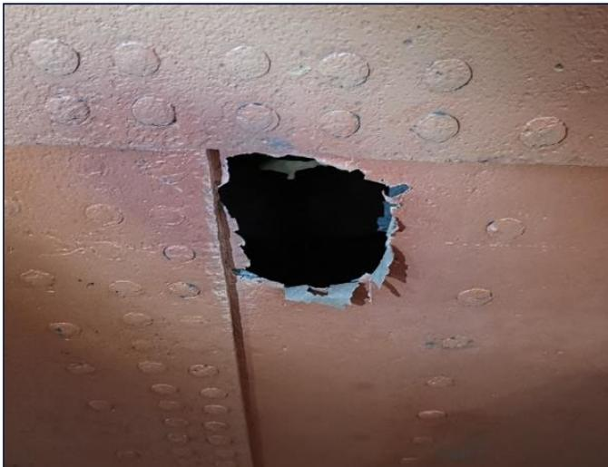
Korrosion Innen mit Auflösung der Spantenstruktur
