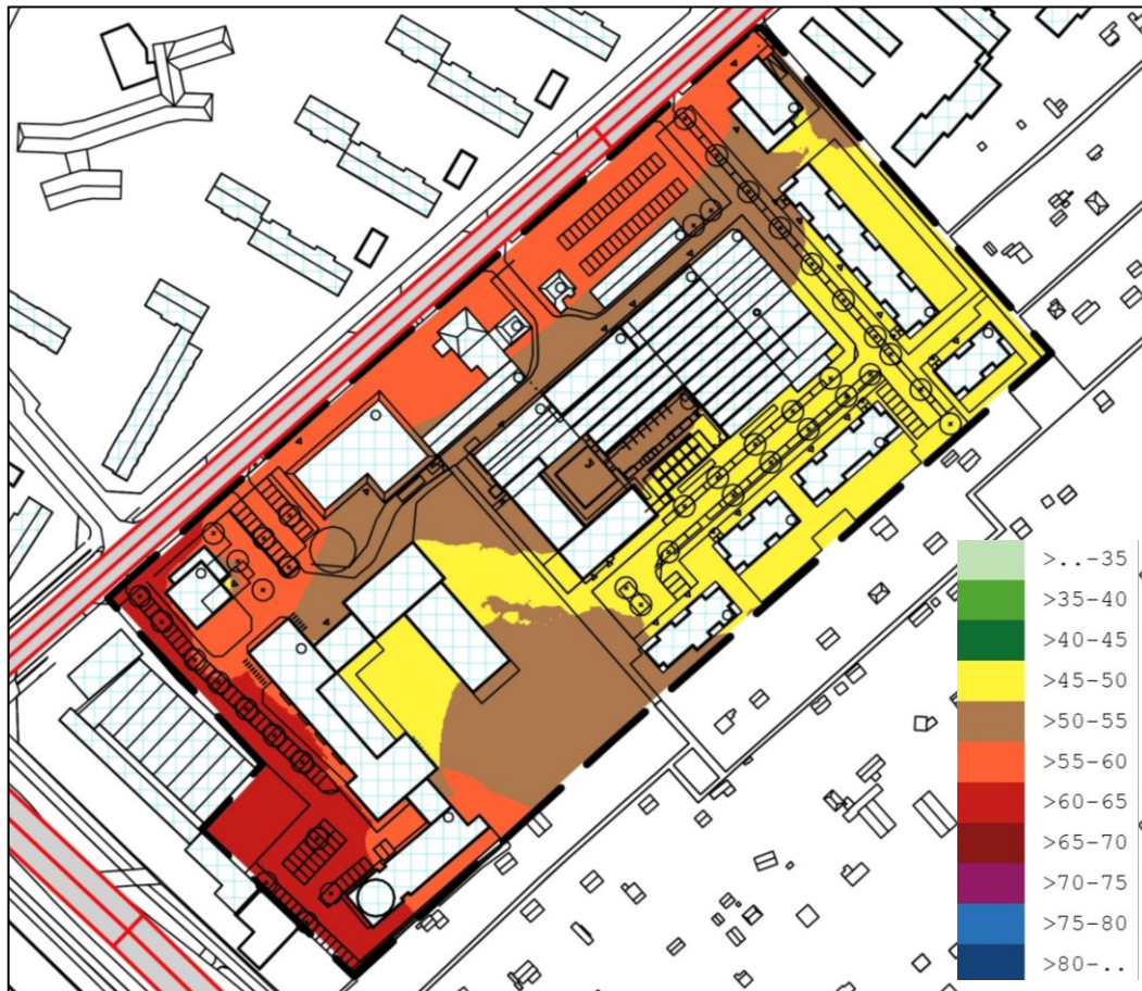
Abb. 4: Immissionsraster Straßenverkehr im Nachtzeitraum, 15,6 m über Geländeoberkante
