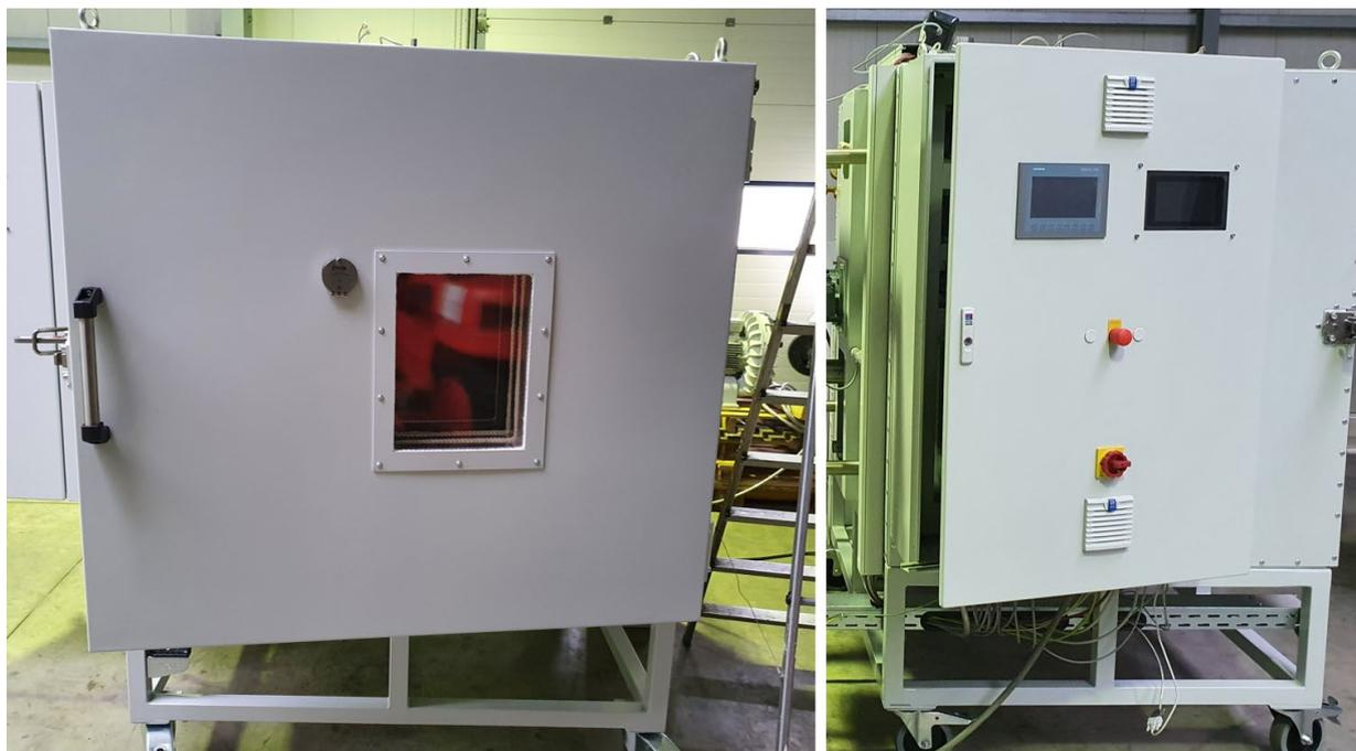
*Abbildung 3: Der Wasserstoffbackofen (links: die Backofentür und rechts: die Schaltfläche)*
