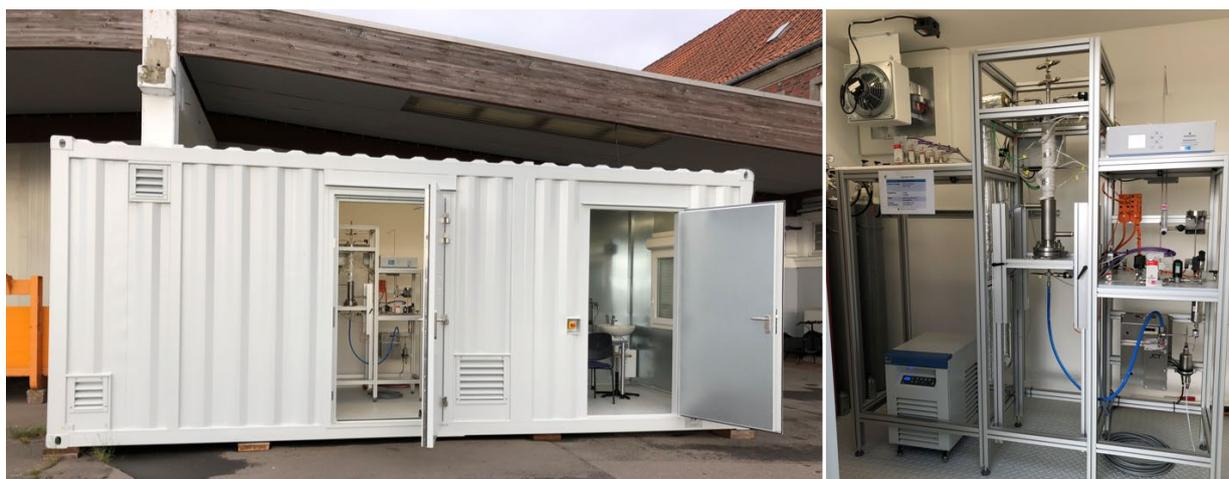
*Abbildung 2: Die E-Fuels Anlage aufgebaut im Container mit Schutzausrüstung zur Verhinderung von Explosionen gemäß ATEX Zone 2.*
