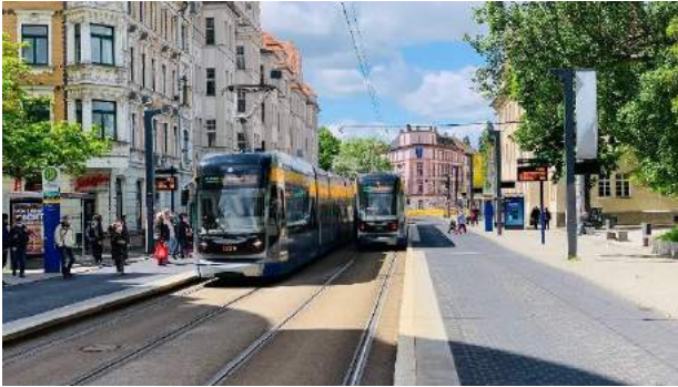
Abbildung 3-20: Haltestelle mit überfahrbarem Kap, Leipzig [Quelle: SKUMS, Blobel]
