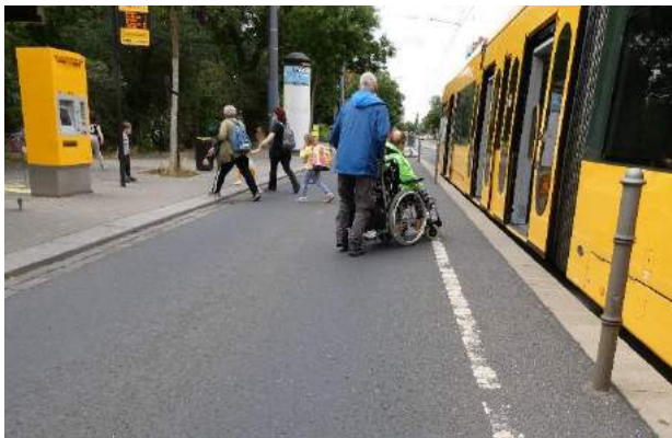
Abbildung 3-17: überfahrbare Haltestelle in Dresden [Quelle: SKUMS, Baute]
