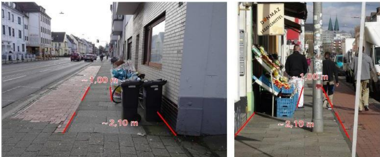
Abbildung 2-18 Auszug Bestandsanalyse Fußverkehr: Nutzungskonflikte auf schmalen Gehwegen; Quelle: SHP Mai 2020, Machbarkeitsstudie Friedrich-Ebert-Straße, 1. Präsentation zum Sachstand Bestandsanalyse
